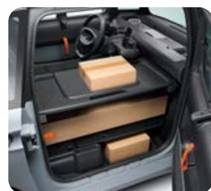
Bandeja superior capaz de soportar un peso de 40 kg
